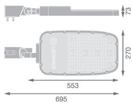
**Scheda tecnica Ledvance Illuminazione Stradale LED Area Extra Large RV35ST Aluminium Grigio 150W 19500lm 155X69D - 730 Luce Calda - | IP66 - Asimmetrico**
