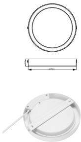
**Scheda tecnica Philips Downlight LED DN065C Metallo Bianca 12W 1200lm 110D - 830 Luce Calda | 175mm - Ritaglio 150mm - IP20**
